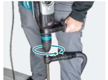
Za varno delo pridržite priključeno cev z roko ali jo naslonite na nogo za preprečitev hkratnega vrtenja s svedrom.
